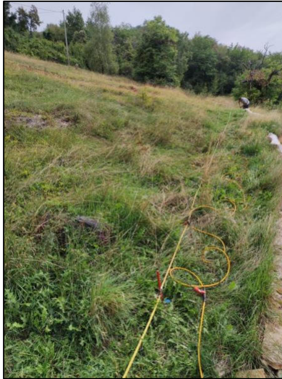
Figura 1: Vista dello stendimento MASW effettuato.
