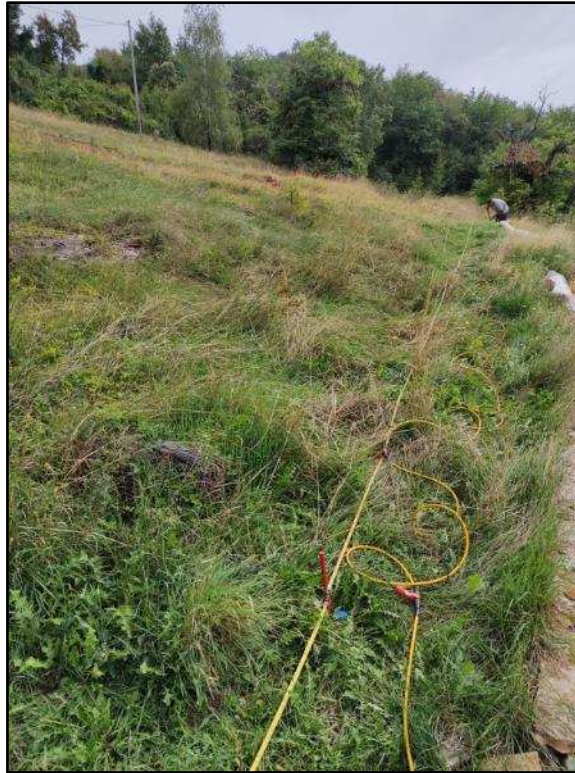
Figura 1: Vista dello stendimento MASW effettuato.
